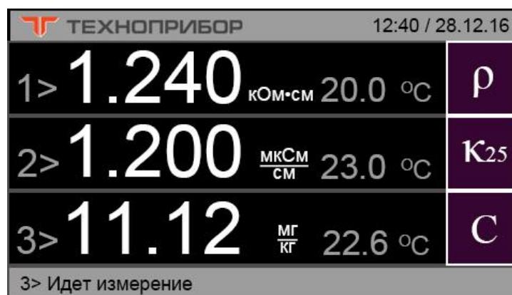
Рис.8. Основной экран (пример для трех каналов кондуктометра).
